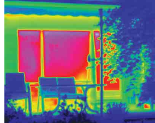
Infrarotaufnahmen – Thermografien – zeigen deutlich, wo ein Haus unkontrolliert Energie verliert. Rot bedeutet Wärme- und damit Energieverlust.
